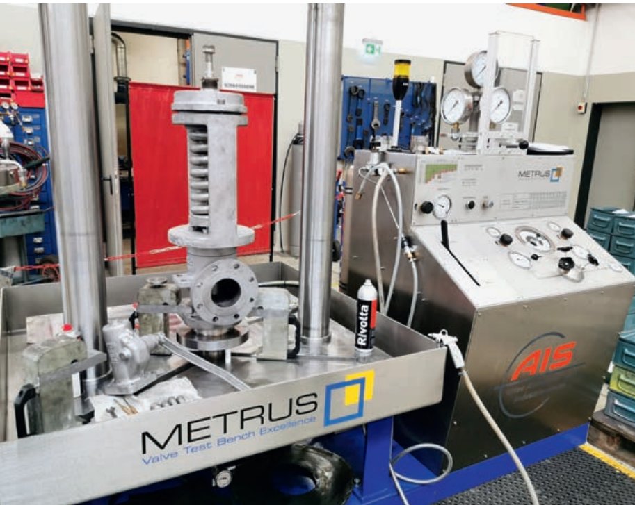
Ein fertig instandgesetztes Sicherheitsventil, bereit zur TÜV-Abnahme. Anschließend wird das Ventil lackiert, an den Kunden ausgeliefert und dort eingebaut.
