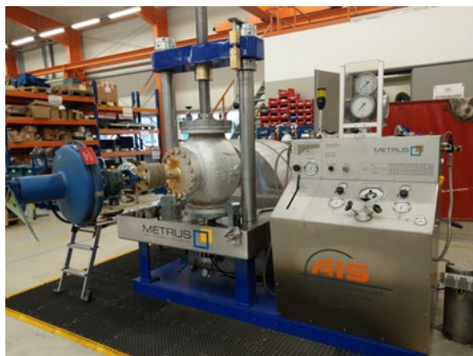
Der neue Ventilprüfstand ist für alle gängigen Armaturenarten wie Ventile, Schieber, Klappen, Sicherheitsventile und Kugelhähne geeignet.
