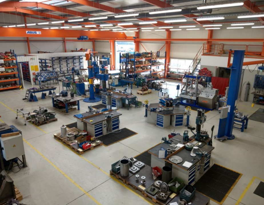
Nach dem Umbau gibt es in der Halle Arbeitsinseln pro Produktgruppe und zwei zusätzliche Säulenschwenkkräne.
