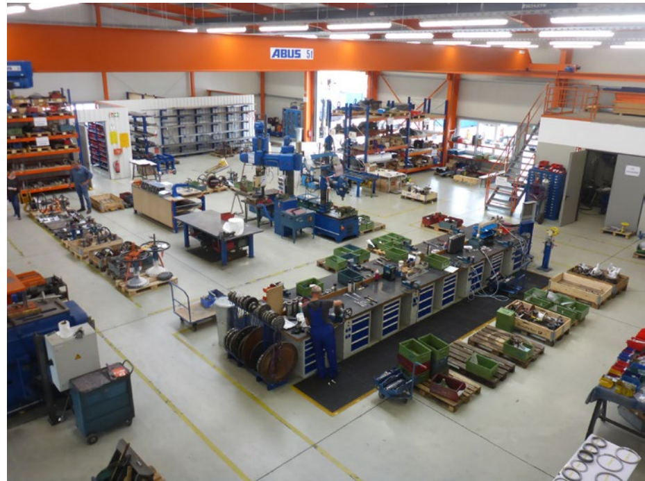
Die Montagehalle der artec AIS vor dem Umbau: Die Werkarbeitsplätze sind in einer Reihe, und es gibt nur eine Krananlage.
