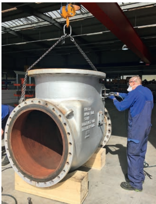
Gehäuse eines Absperrschiebers DN900 in Überarbeitung
