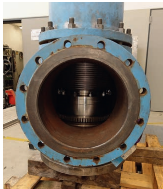
Sempell Sicherheitsventil DN200/250 nach Überholung und TÜV-Abnahme auf Versandpalette montiert. Sicherheitsventile müssen nach der Überarbeitung immer stehend transportiert werden, damit die sensiblen Dichtflächen nicht beschädigt werden.
